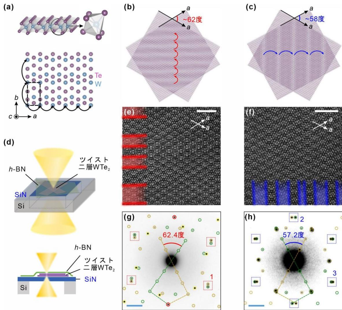
図1：透過型電子線顕微鏡を用いたツイスト二層 WTe<sub>2</sub>の原子像観察。
