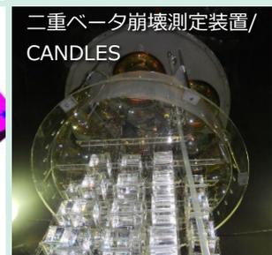
これらの装置を用いて、0.1eV未満から200GeV超まで12桁にわたる広いエネルギー領域で、素粒子原子核の性質を調べます。
