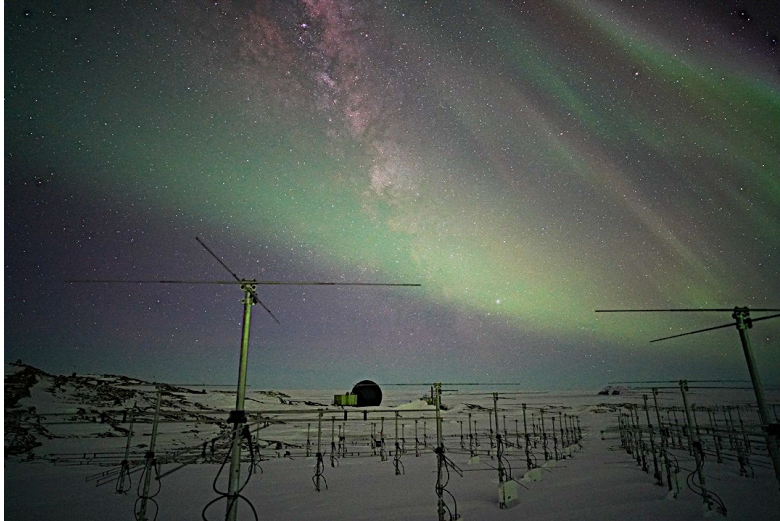
図 1：南極昭和基地の大型大気レーダー「PANSY レーダー」のアンテナ群。
