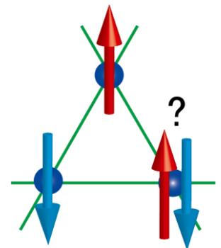
図2 スピンのフラストレーション。矢印の向きがスピンの向きを表す。
