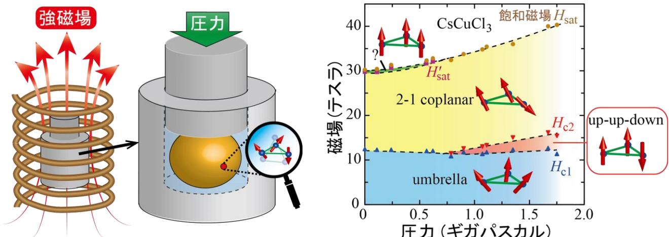
図1(左):強磁場高圧力下磁化測定装置の概略図。パルス強磁場・高圧力発生装置の内部に試料と磁化検出コイルの両方を配置することで強磁場・高圧力下における微弱な磁化検出に成功。(右)三角格子反強磁性体  $\text{CsCuCl}_3$  の磁場-圧力相図。飽和磁場は、圧力増加に伴い高磁場側に移動し、最高圧力 1.7 ギガパスカルで 40 テスラまで到達。
