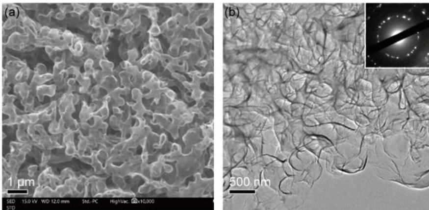
図1.窒素ドープした3次元ナノ多孔質グラフェン電子顕微鏡像。
