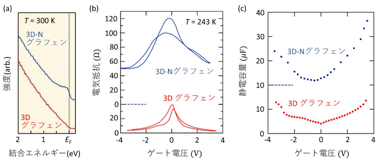
図2. 窒素ドープした3次元ナノ多孔質グラフェンの電子状態。
