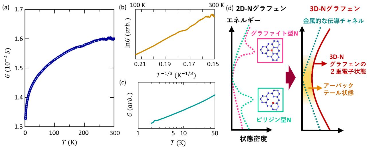
図 3. 窒素ドープした 3 次元ナノ多孔質グラフェンの規格化した電気伝導度の温度依存性。
