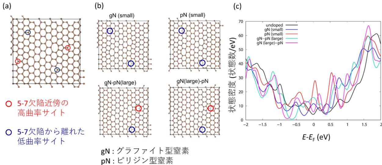
図 4. 数理モデルから見た窒素ドープしたグラフェンによる 3 次元的な曲面の電子状態
