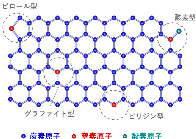
図 6. 窒素ドープグラフェンの模式図。
