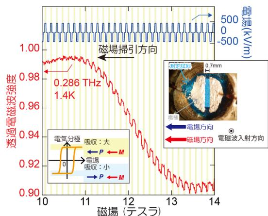
図 2. 開発した交流電場印加下での電子スピン共鳴測定による非相反線二色性の観測。外部からの交流電場印加による電気分極の反転に伴い、電磁波の吸収量が増減し、透過電磁波強度が振動している。
