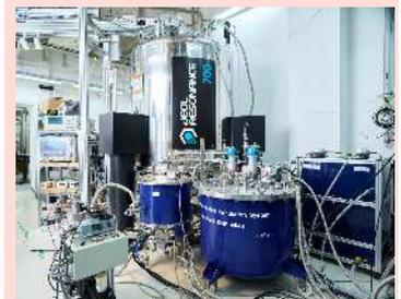
開発したスピン超偏極固体NMR装置
