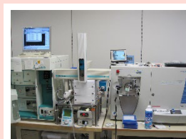
微量タンパク質を解析できる質量分析器
