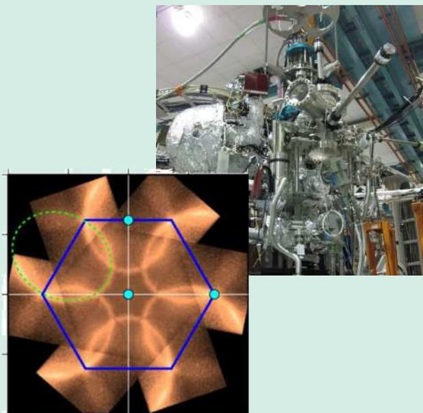
放射光角度分解光電子分光装置 (上) と、この装置を用いて観測したトポロジカル近藤絶縁体SmB<sub>6</sub>(111)表面のフェルミ面 (下)。
