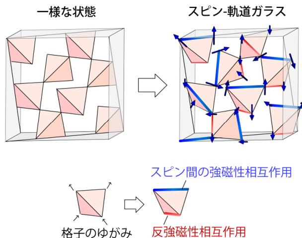
図：パイロクロア格子のひずみがない一様な場合(左)と正四面体がばらばらにひずんだ状態(右)。ひずみによって離れた電子スピン間で強磁性的に揃おうとする相互作用(青太線)と、反強磁性的に向きを逆にそろえようとする相互作用(赤太線)が乱れた配置で生じる。四面体の頂点にあるモリブデンスピンがこれと連動してガラス的に乱れた状態になる。
