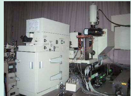
Ar-Krレーザーを使ったラマン散乱分光器
