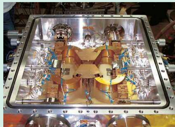
当グループで開発したマルチターン飛行時間型質量分析計「MULTUM Linear plus」。
