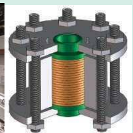
大型コンデンサーバンクシステムとワイドボアパルスマグネットのカットビュー
