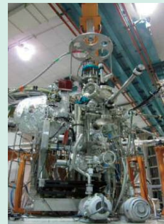
固体の電子状態をつぶさに観測できる三次元運動量・軌道対称性分解光電子分光装置。
