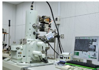
電界放出形走査電子顕微鏡 試料表面の形状をナノ領域で画像化したり元素分析を行う装置。拡大可能倍率100万倍。サームル型なのでエミッション電流量が非常に大きい。
