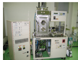
多目的電子ビーム蒸着装置 特殊仕様で蒸着中のサンプルの回転、高さ変更、傾斜などが可能な高真空蒸着装置。 アネルバ製。
