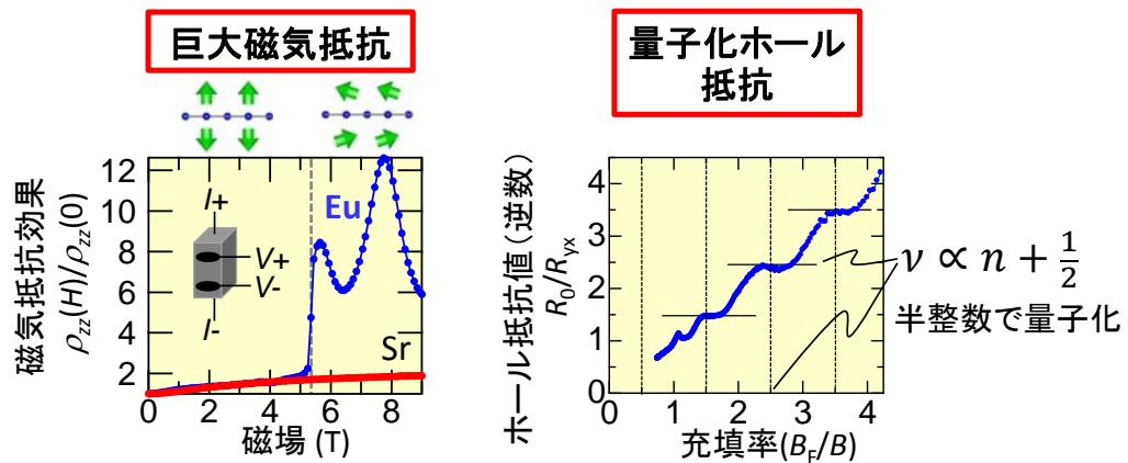
図 2：(左) EuMnBi<sub>2</sub> のディラック電子層に垂直方向の電気抵抗の外部磁場依存性。グラフ上部に描かれているように、ユーロピウムの磁気モーメントの向きを水平方向へ変化させると、EuMnBi<sub>2</sub> の電気抵抗（青）は急激に上昇することがわかる（磁気抵抗効果）。これは、ディラック電子が二次元的な面内に強く閉じ込められることを意味する。一方、磁石の性質を持たない SrMnBi<sub>2</sub>（赤）では、外部磁場により電気抵抗を大きく変化させることができない。挿入図は、電気抵抗の測定法の模式図。
