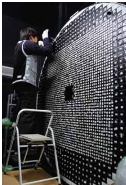
J-PARC大強度陽子加速器施設で建設中のガンマ線測定器
