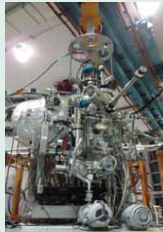
固体の電子状態をつぶさに観測できる三次元運動量・軌道対称性分解光電子分光装置。
