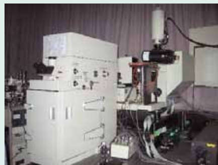
Ar-Krレーザーを使ったラマン散乱分光器
