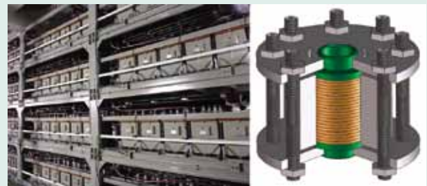
大型コンデンサーバンクシステムとワイドボアパルスマグネットのカットビュー
