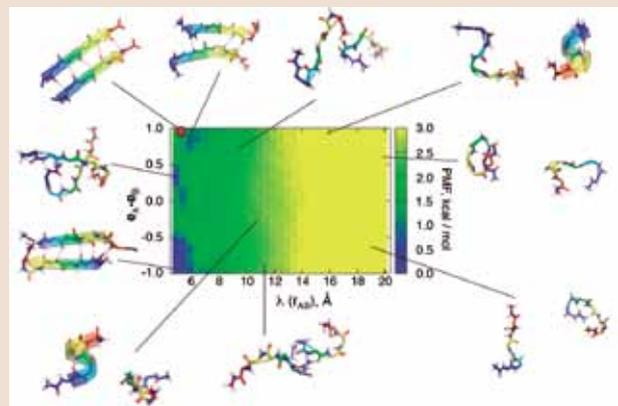
V-AUS (Virtual-state coupled Adaptive Umbrella Sampling) 法によって得られた2本のアルツハイマー・ペプチドのホモ・ダイマー形成における300Kでの自由エネルギー地形とその構造多型。横軸はペプチド中心間の距離、縦軸は方向単位ベクトルの内積で、グラフ中の色が自由エネルギー値を表します。左上の赤丸が結晶構造に対応しています。(Higo et al. *J. Comput. Chem.* 36, 1489-1501, 2015)
