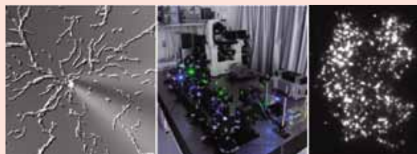
左：細胞性粘菌 Dictyostelium discoideum の走化性応答。中：細胞内1分子イメージング装置。右：細胞内1分子イメージング装置で撮影したPTEN分子の1分子画像。白い1点1点がPTEN1分子である。細胞が環境からのシグナルを受容し、シグナルを伝達する過程で個々の分子がどのような挙動を示すのかを調べることで、シグナル伝達の仕組みを明らかにする。
