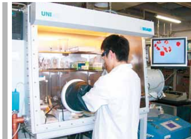
酸素濃度5ppm以下の環境下における有機物単結晶の育成
