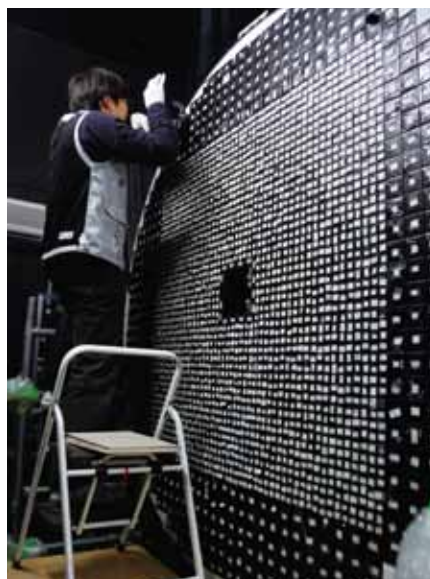
J-PARC大強度陽子加速器施設で建設中のガンマ線測定器
