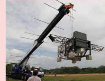
図2:恒星の周りでどんなふう惑星が作られているかを探るために、世界最高性能を持つ遠赤外線干渉計(FITE)を開発しました。気球に搭載して観測しようとしています。
